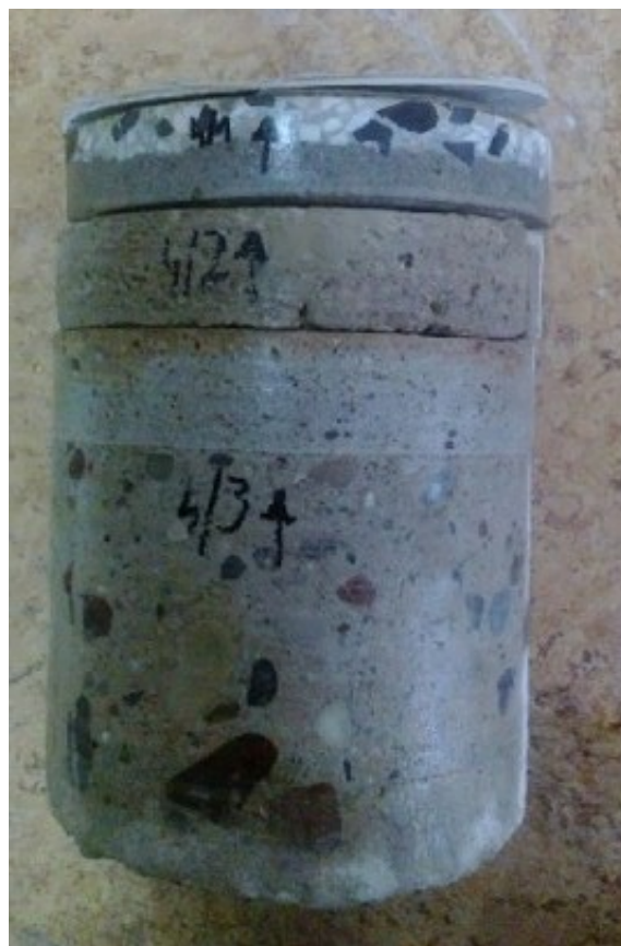
Fotografie rdzeni wyciętych z otworów badawczych P3 i P4 przy ul. Fabrycznej
