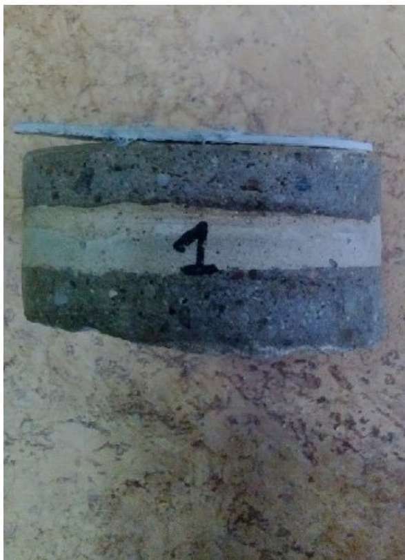
Fotografie rdzeni wyciętych z posadzki w otworze badawczym nr P1 i P2 przy ul Fabrycznej.
