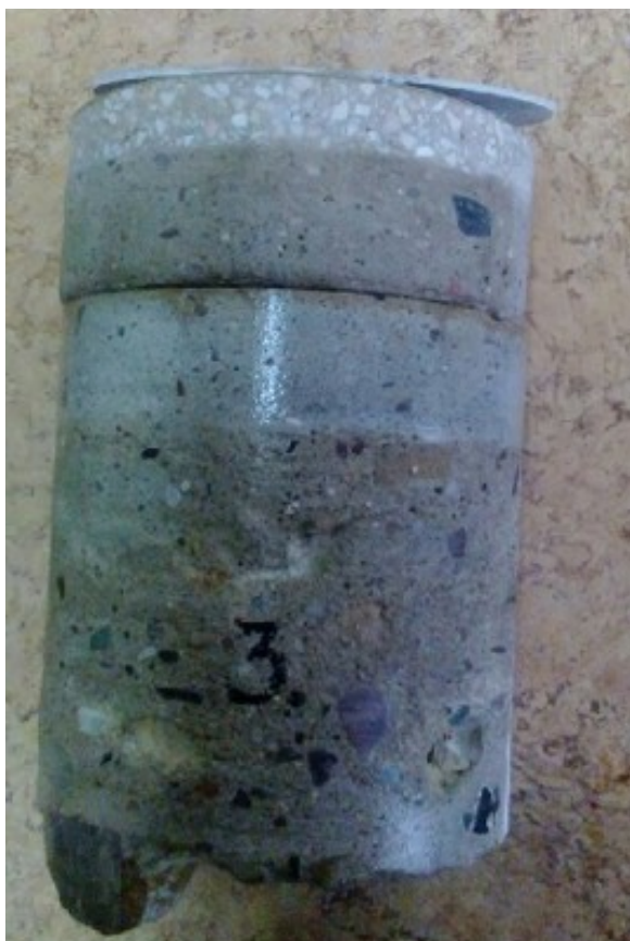
Fotografie rdzeni wyciętych z otworów badawczych P3 i P4 przy ul. Fabrycznej
