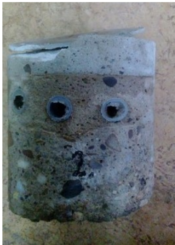
Fotografie rdzeni wyciętych z posadzki w otworze badawczym nr P1 i P2 przy ul Fabrycznej.
