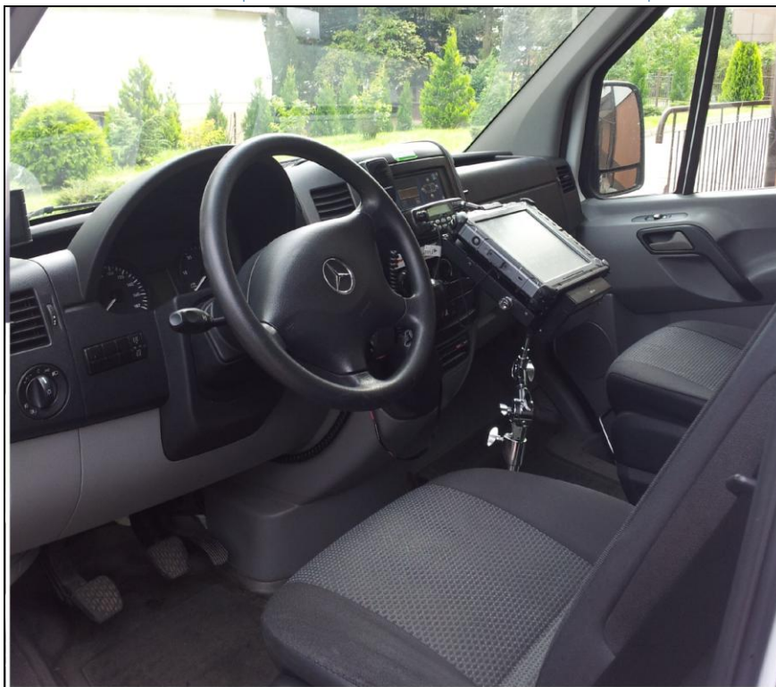
Rysunek 4 Zainstalowany zestaw mocujący terminal mobilny w kabinie kierowcy (zdjęcie 2)
