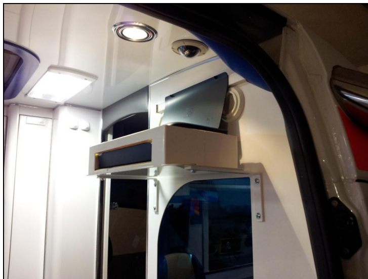
Rysunek 6 Mocowanie drukarki w wersji A
