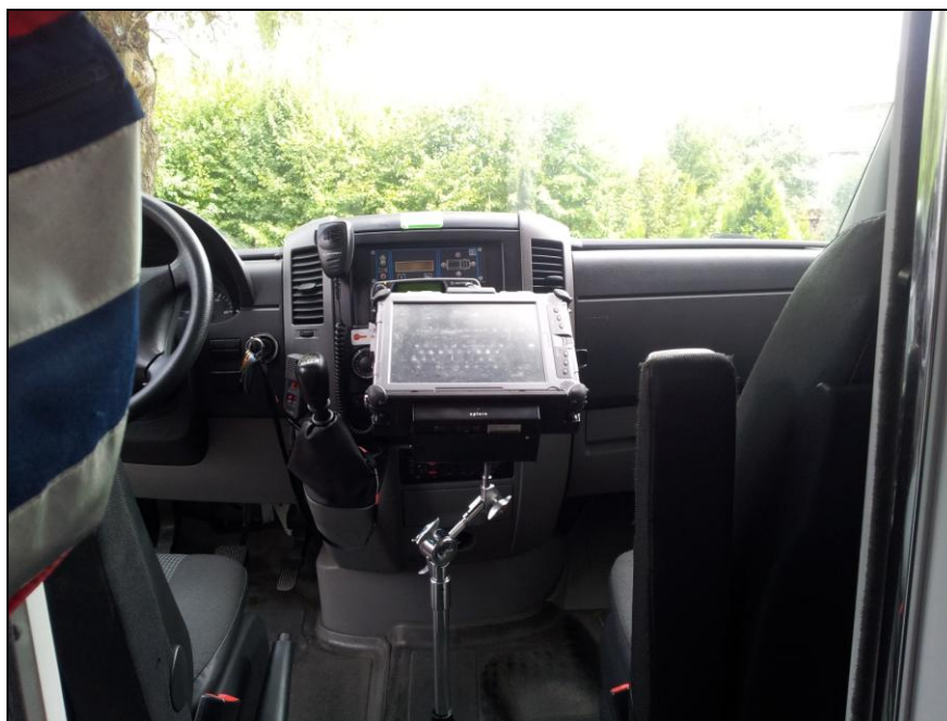
Rysunek 5 Zainstalowany zestaw mocujący terminal mobilny w kabinie kierowcy (zdjęcie 3)
