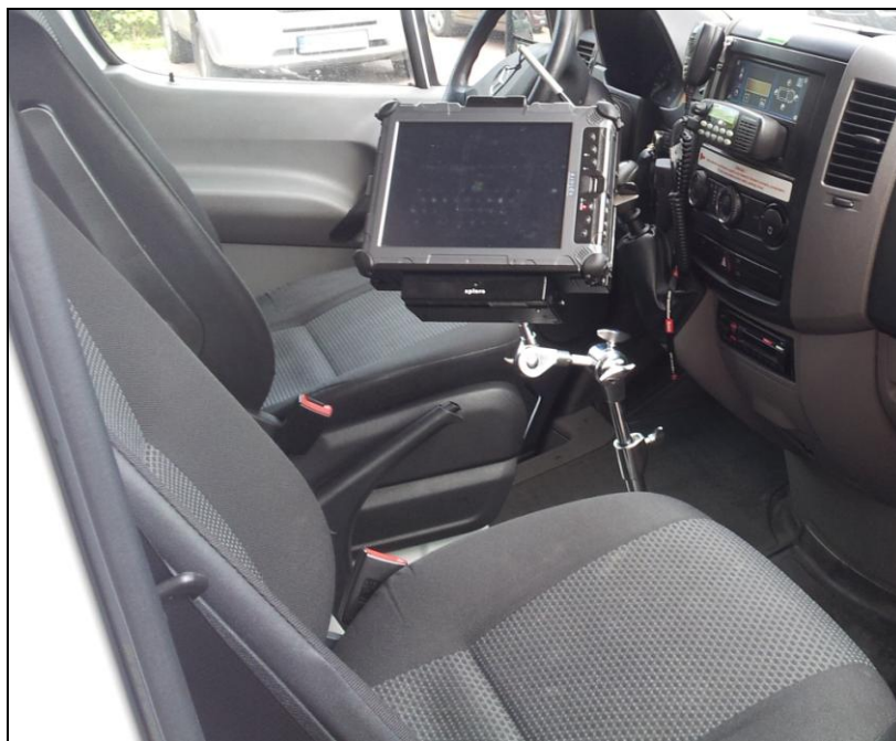
Rysunek 3 Zainstalowany zestaw mocujący terminal mobilny w kabinie kierowcy (zdjęcie 1)
