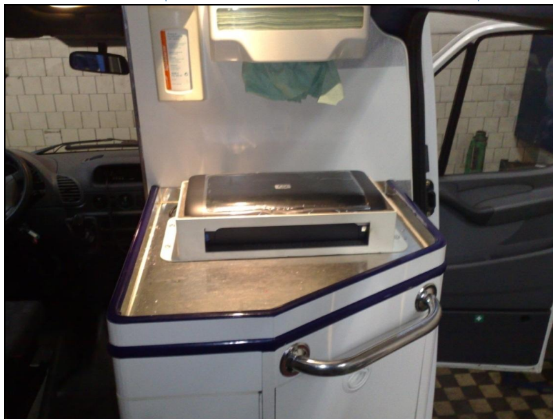
Rysunek 7 Mocowanie drukarki w wersji B
